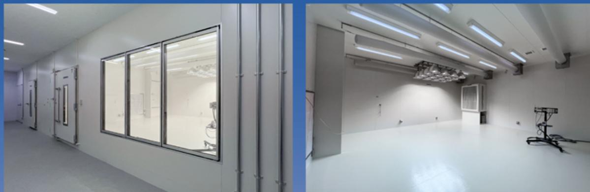
特注・ハイグレード型 運動生理学用試験研究装置 [PATENT] 温度:-30~40℃ 湿度:30~80% 2室仕様 (1室はHC機能を含む)
